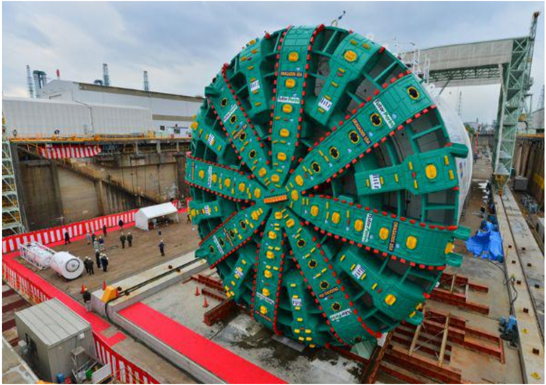
图 5.圆形截面盾构机
