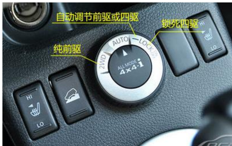
日产逍客电控适时四轮驱动系统控制旋钮
