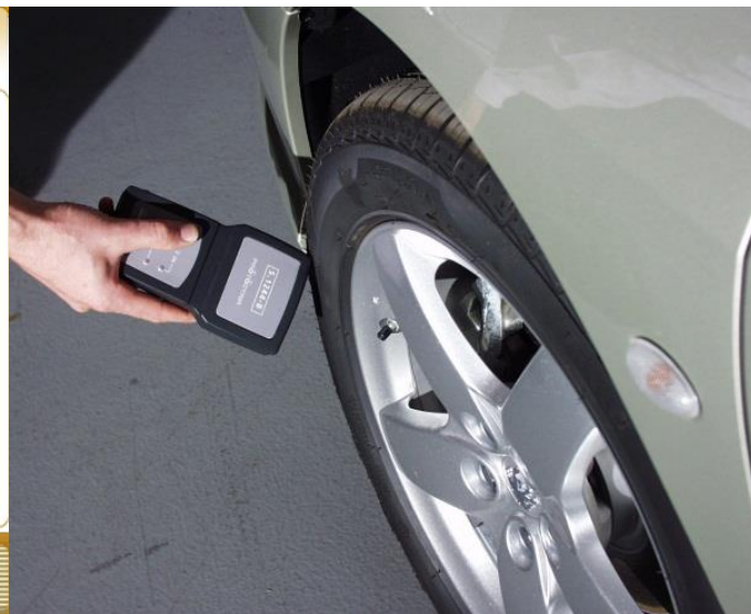
车轮发射器模块触发器初始化
